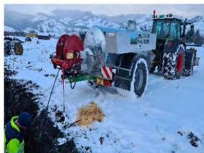
Altes und neues Spülfass, sowie das neue Spülfass im laufenden Einsatz, Fotos: Markus Keel
